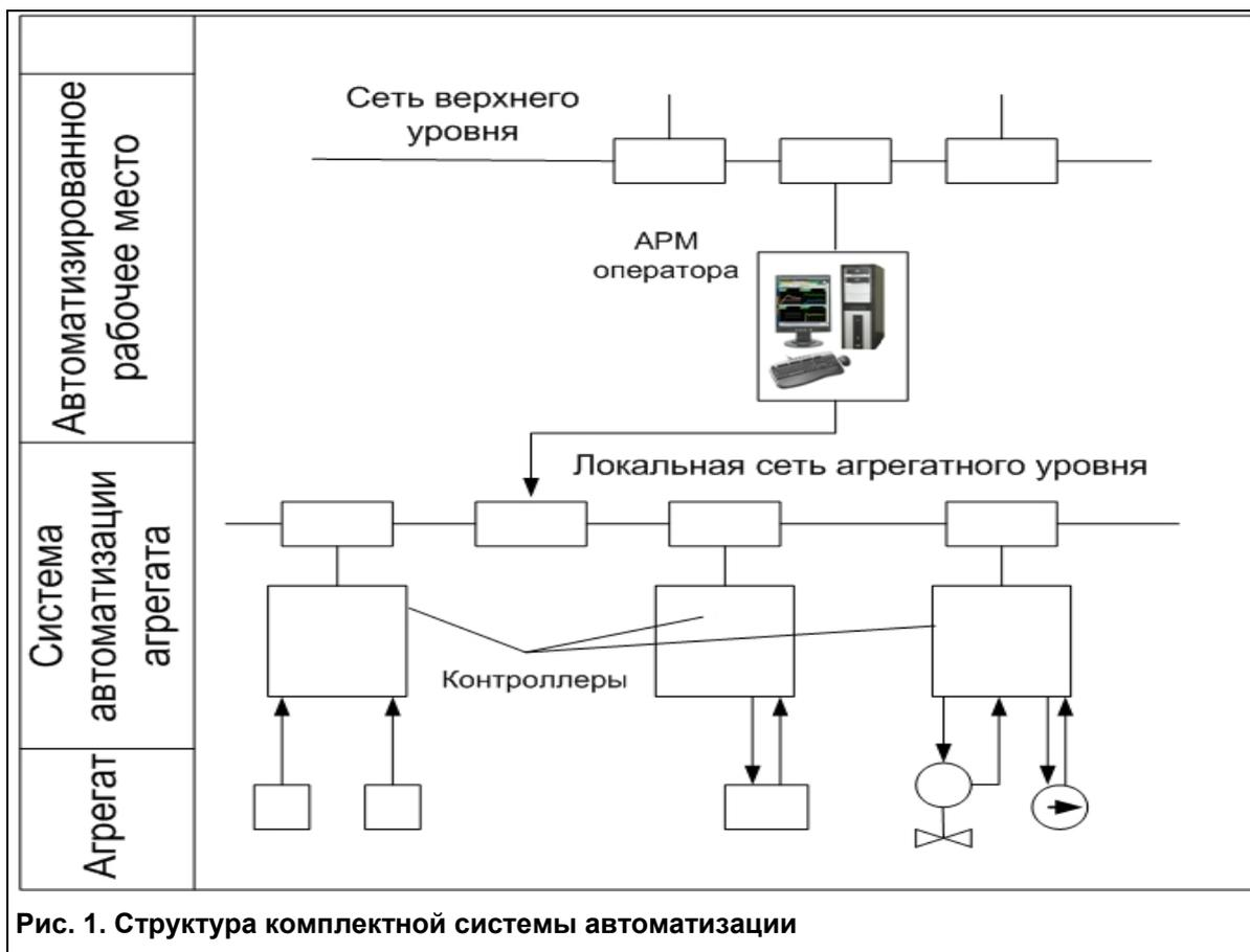
Рис. 1. Структура комплектной системы автоматизации
